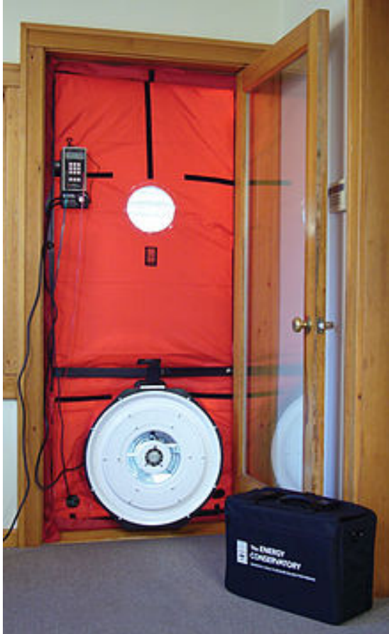
Blower door (envelope leakage)
