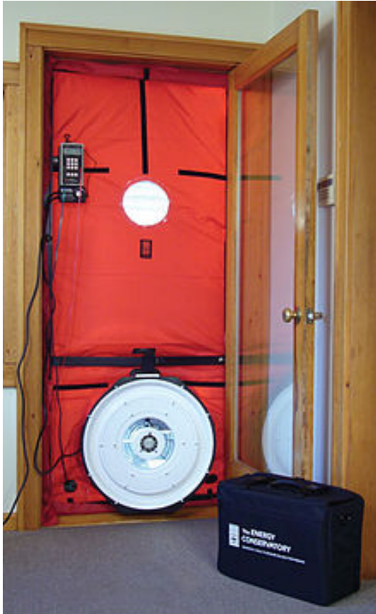
Blower door (envelope leakage)
