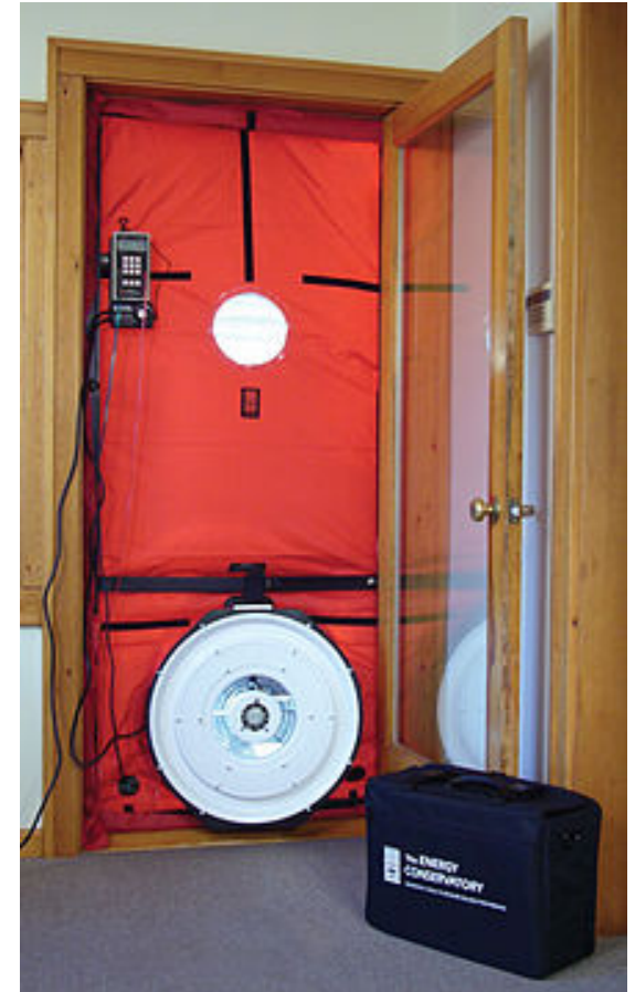
Blower door (envelope leakage)
