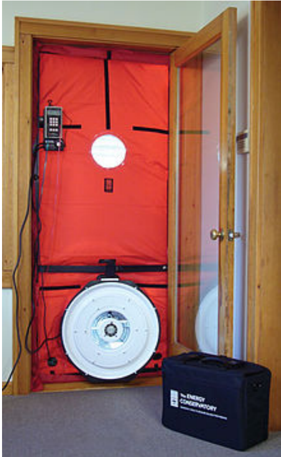
Blower door (envelope leakage)
